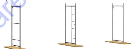
В башмаки поочередно установить на необходимую длину лесов рамы первого яруса, соединяя их горизонтальными и диагональными стяжками. По краям необходимой длины лесов установить рамы с элементами ограждения, а следующая рама должна быть с лестницей.
