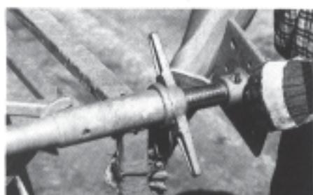
Деталь: фиксатор винтовой ножки
