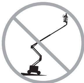
Стрелу разрешается поднимать и выдвигать, только если машина находится на устойчивой и ровной поверхности.
