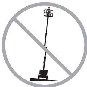
Если звуковой сигнал наклона включается при опущенной стреле: не выдвигайте стрелу, не поворачивайте и не поднимайте ее выше горизонтального
