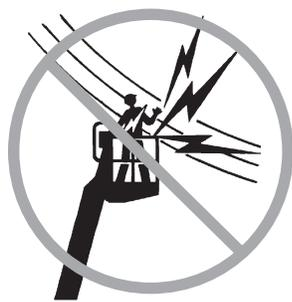
Машина не изолирована электрически и не обеспечивает защиты в случае прикосновения к токоведущим частям или приближения к ним.
