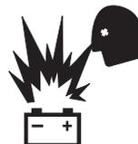
Вблизи от аккумуляторов не должно быть искр и пламени; возле них нельзя курить. Аккумуляторы выделяют взрывоопасный газ.
