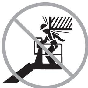
Проверьте рабочую зону на предмет препятствий в воздухе или иных возможных источников опасности.
