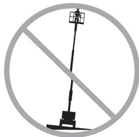
Не полагайтесь на звуковой сигнал наклона как на показатель выравнивания машины. Звуковой сигнал наклона на рабочей площадке включается, только если машина находится на крутом склоне.
