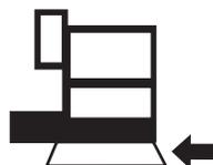
Если рабочая площадка бампером сталкивается с препятствием, машина выключается, и никакие ее функции не работают.
