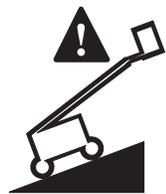
Если звуковой сигнал наклона сработает при поднятой рабочей площадке, загорится индикатор «Машина не выровнена» и перестанет работать функция движения в одном или обоих направлениях. Определите положение стрелы по отношению к склону, как показано ниже. Прежде чем переместиться на устойчивую и ровную поверхность, выполните указанные ниже операции, чтобы опустить стрелу. Не поворачивайте стрелу при опускании.
