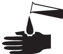
Аккумуляторные батареи содержат электролит. При работе с аккумуляторами всегда надевайте защитную одежду и очки.
