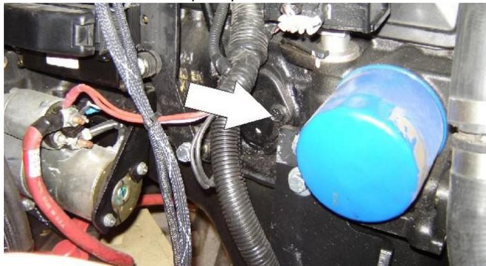
Точки смазки — заливная крышка / навинчиваемый элемент
