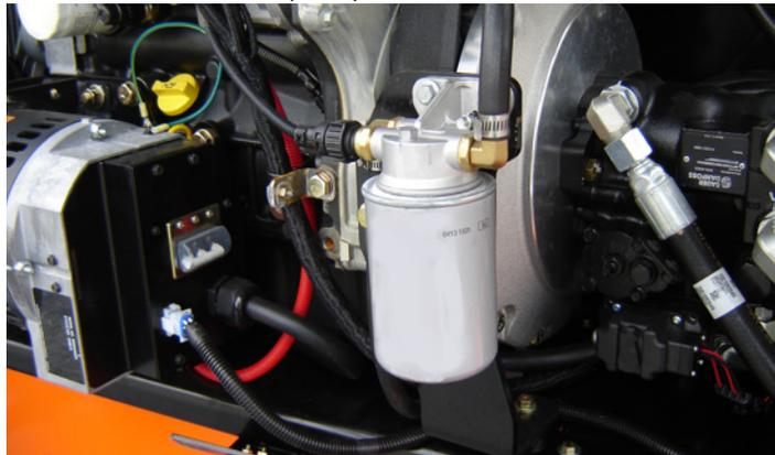
Точки смазки — заменяемый элемент
