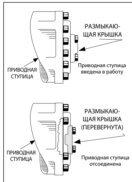
Рис. 4–5. Ступица, отсоединяющая привод
