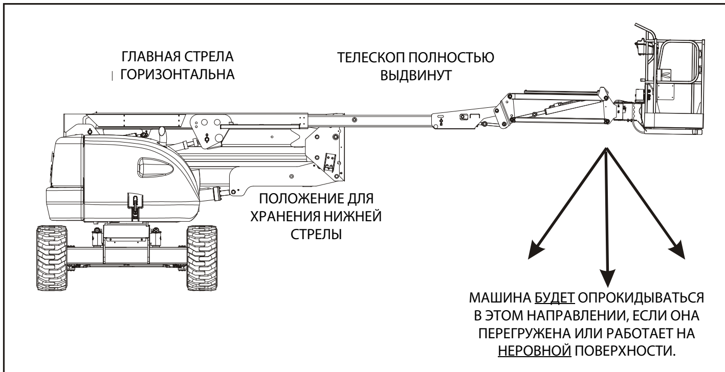
Рис. 4-1. Положение минимальной устойчивости против опрокидывания вперед
